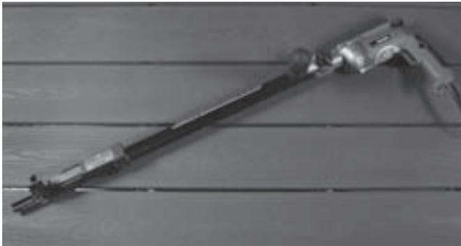
Posez les fixations Trex recommandées avec des perceuses mécaniques standard ou des pistolets à vis approuvés.
