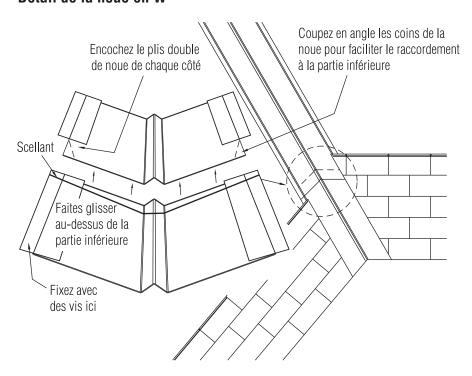
La noue devrait suivre la ligne centrale de la vallée du toit. Afin de préserver un aspect net et uniforme, assurez-vous que la noue est bien alignée. Commencez par installer à partir de l'avant-toit. La première section de noue chevauchera la rangée de départ de l'avant-toit. Fixez la noue à tous les 16 po sur toute sa longueur sur les deux côtés. L'extrémité de la noue doit être coupée sur les angles correspondant aux deux sections de toit adjacentes.
