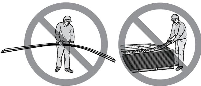
**Mauvaise manutention :** Lors du transport des panneaux de fibro-ciment, soutenir le produit sur sa longueur.
